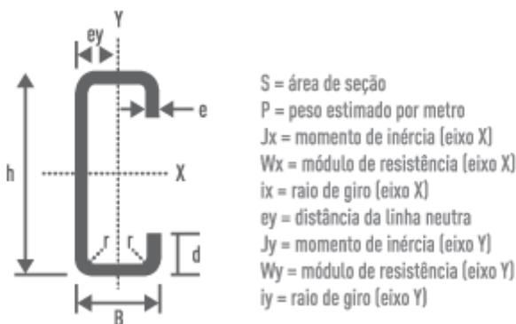
**Foto 6- Perfil adotado para dimensionamento de pilar metálico**
