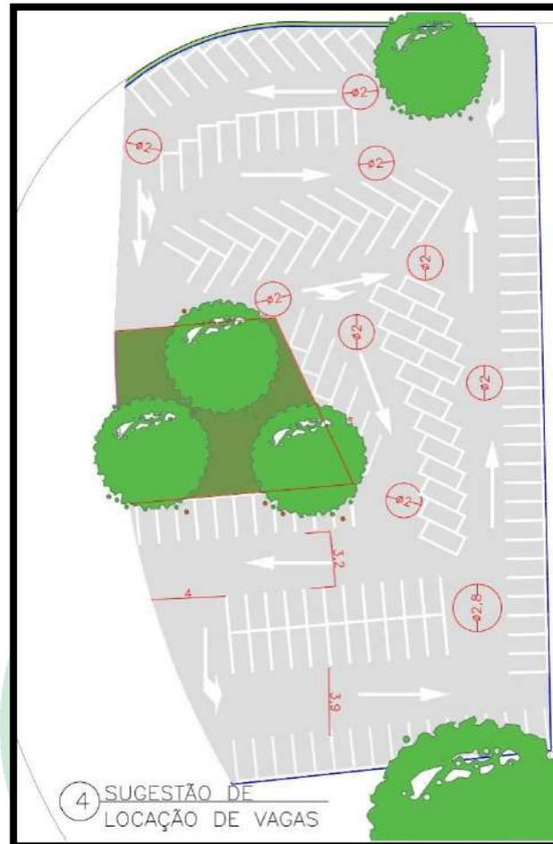
Foto 8 - Disposição de Vagas de Estacionamento
