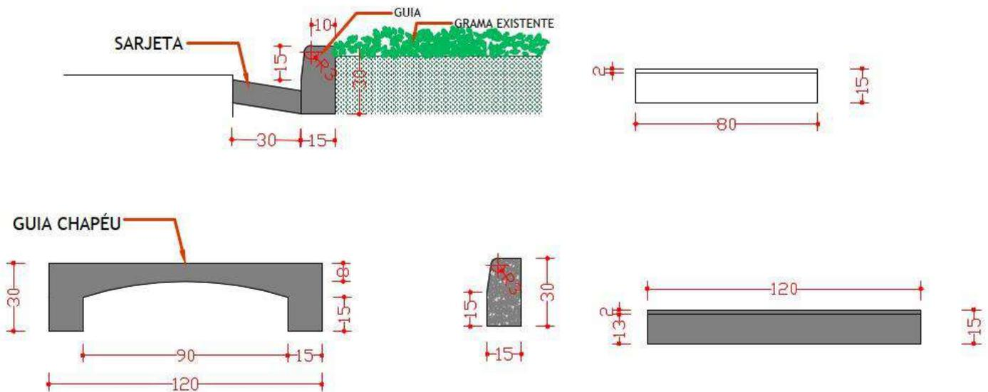
Foto 4 - Detalhamento das guias para serem executadas no estacionamento.
