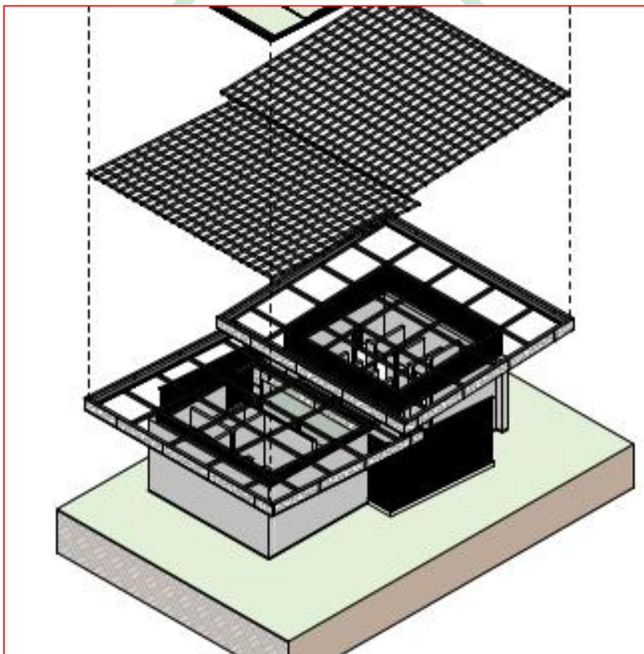
Figura 15 - Detalhe explodido da estrutura primária e secundária da cobertura - Fonte: CEASA/PR e AUEN
