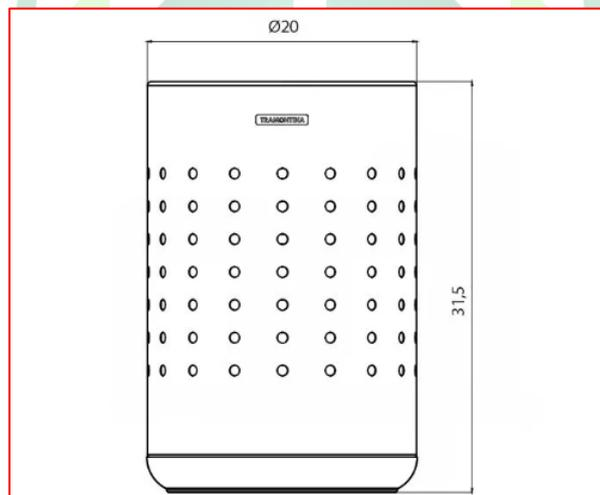
Figura 62 - Cesto para papel metálico, 10l - Fonte: Tramontina
