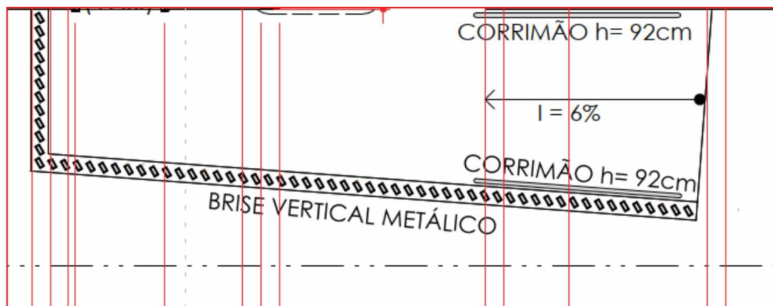
Figura 41 - Detalhe em planta de Brise Metálico Vertical – Fonte: CEASA/PR e AUEN
