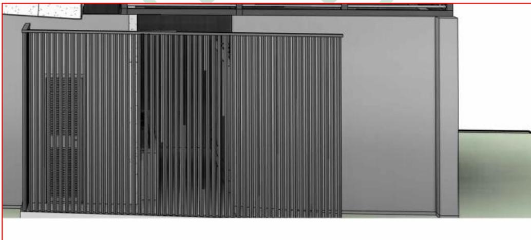
Figura 40 - Detalhe em vista de Brise Metálico Vertical – Fonte: CEASA/PR e AUEN
