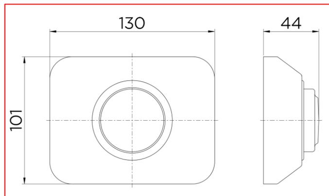
Figura 59 - Detalhe técnico da válvula - Fonte: DOCOL
