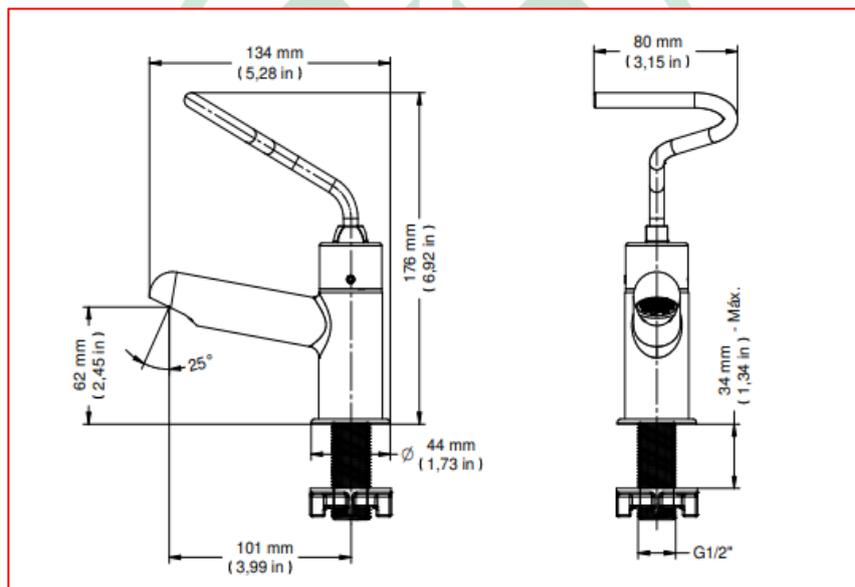
Figura 55 - Especificação de torneira a instalar - Fonte: DOCOL
