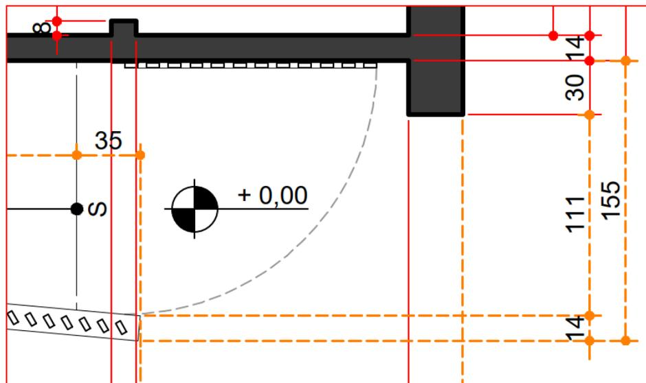
Figura 39 - Portão de ferro de entrada de abrir, conforme projeto – Fonte: CEASA/PR e ARCHSALLES
