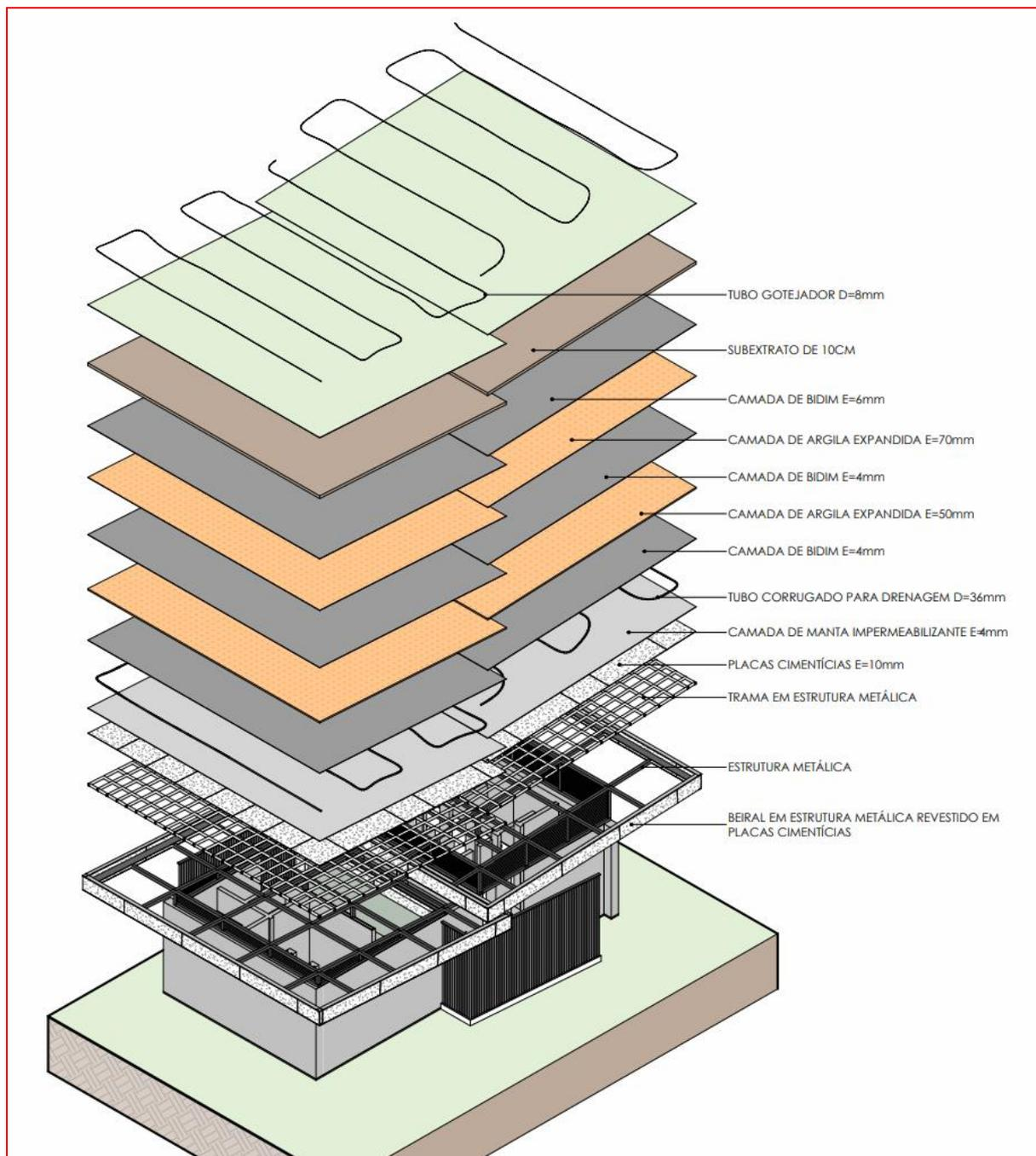
Figura 42 - Detalhe explodido de camadas do telhado verde a ser instalado – Fonte: CEASA/PR e AUEN
