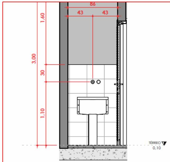
Figura 21 - Parede hidráulica do DML – Fonte: CEASA/PR e AUEN
