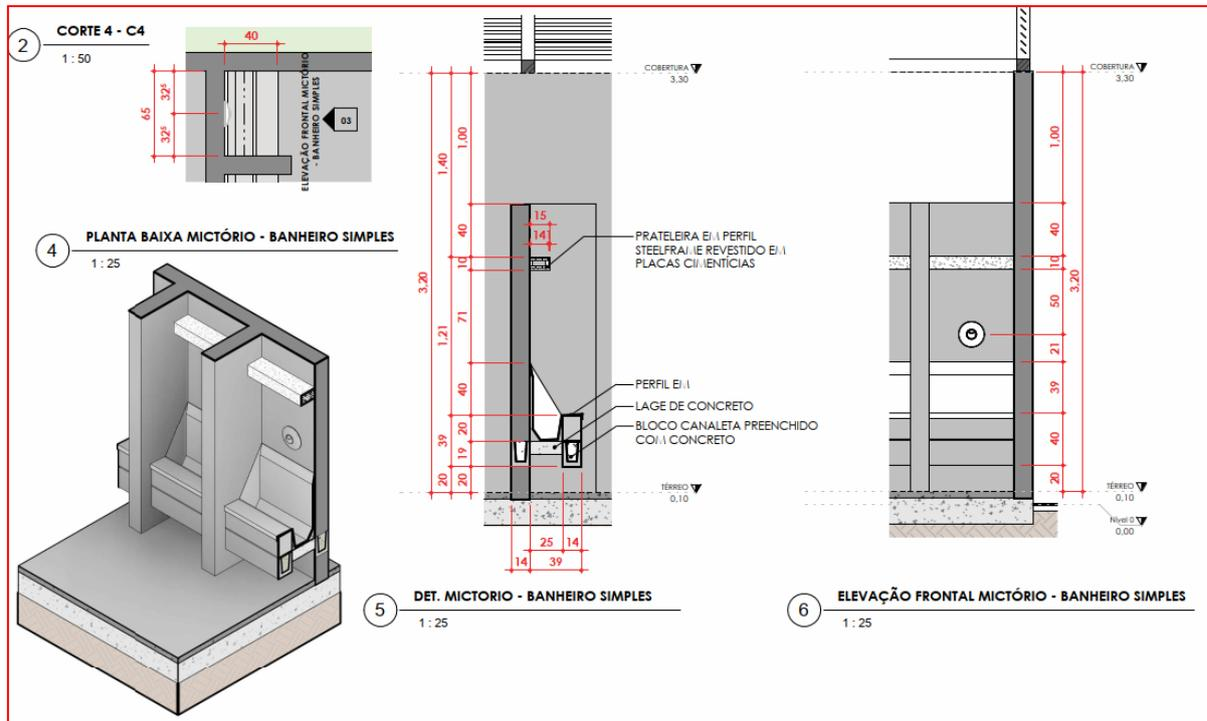
Figura 66 - Detalhes técnicos dos módulos de mictório - Fonte: CEASA/PR e AUEN
