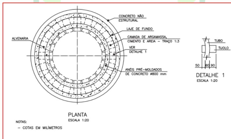
Figura 11 - Execução de PV - tipo A - conforme SANEPAR - planta - Fonte: SANEPAR
