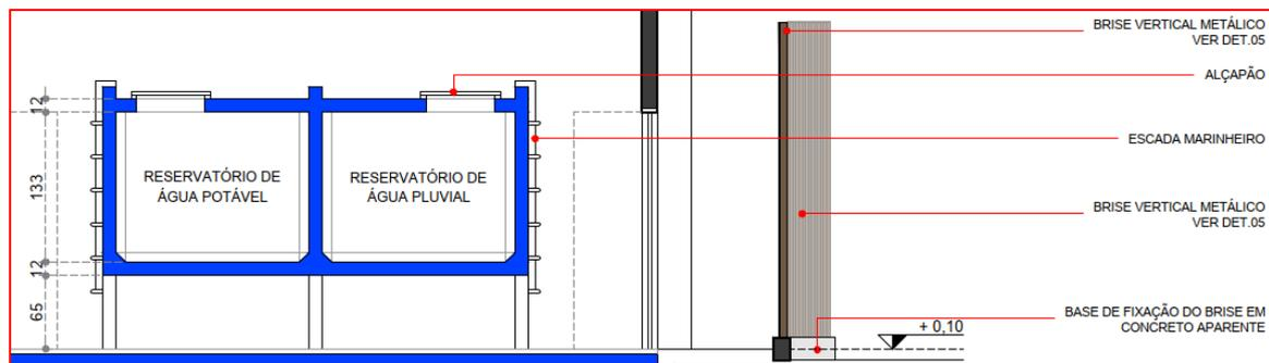
Figura 34 - Detalhe de Escada Marinheiro e porta alçapão - Fonte: CEASA/PR e ARCHSALLES
