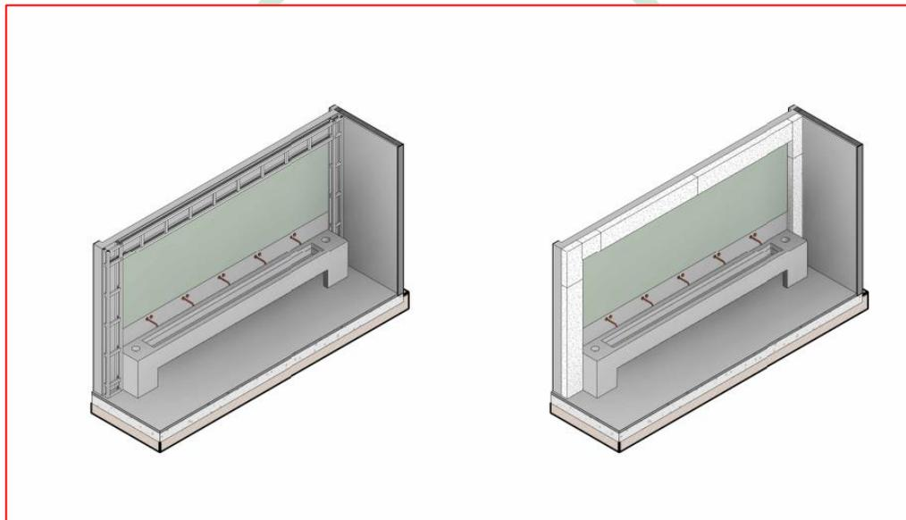
Figura 22 - Detalhes em steel-frame do lavatório - Fonte: CEASA/PR e AUEN
