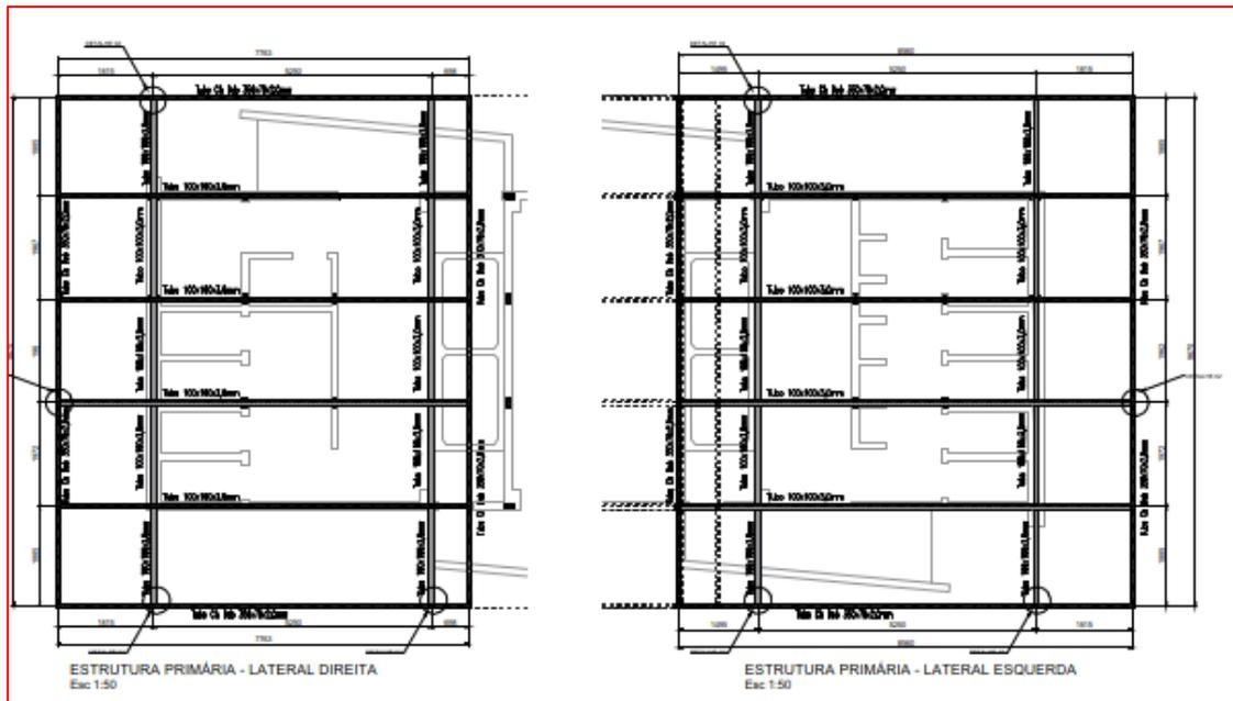
Figura 13 - Projeto Estrutural da Cobertura - Fonte: CEASA/PR e FUNDAMENTO ENGENHARIA
