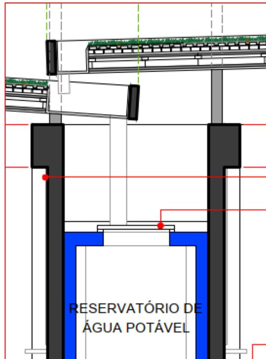
Figura 73 - Detalhe de coleta de águas pluviais para cisterna de água – Fonte: CEASA/PR e ARCHSALLES
