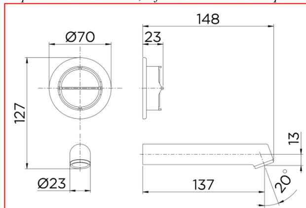
Figura 69 - Especificação de torneira a instalar - Fonte: DOCOL
