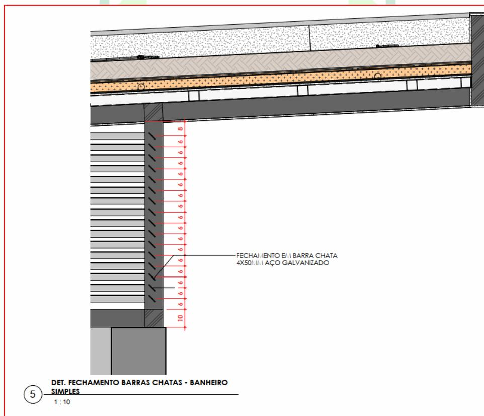
Figura 14 - Detalhe do fechamento lateral com barra chata - Fonte: CEASA/PR e AUE
