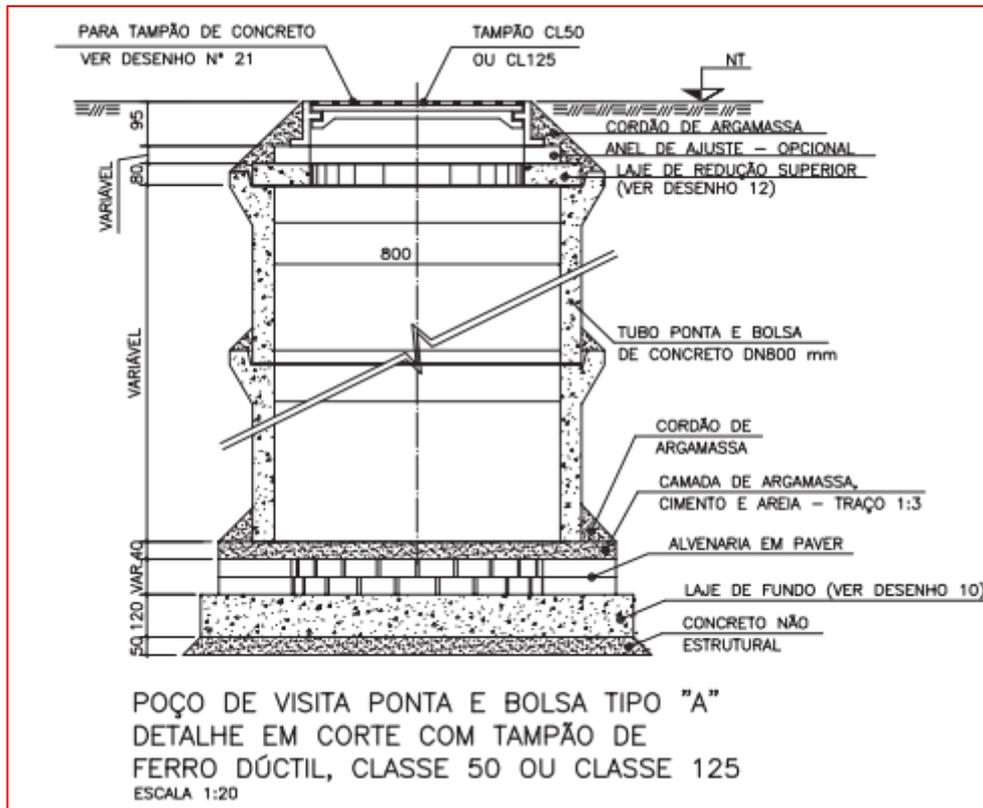
Figura 10 - Execução de PV - tipo A - conforme SANEPAR - corte - Fonte: SANEPAR
