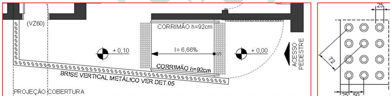
Figura 18 - Detalhamento do piso tátil a ser instalado - CEASA/PR e AUEN
