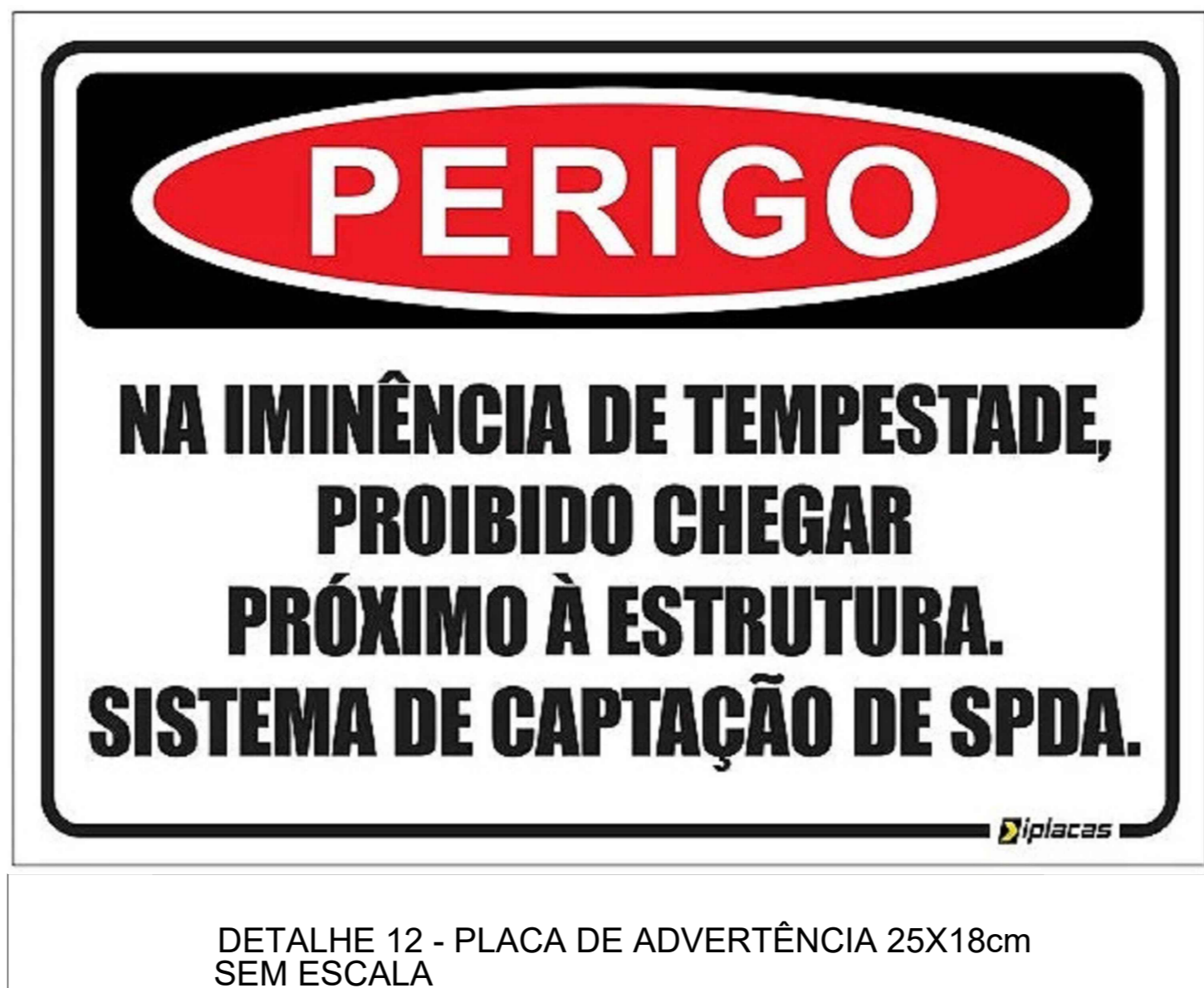
DETALHE 12 - PLACA DE ADVERTÊNCIA 25x18cm SEM ESCALA
